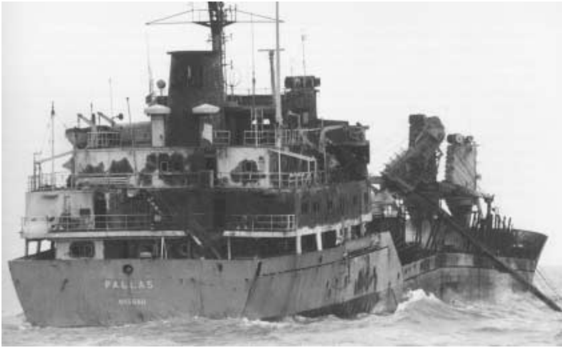
Abb. 50: Die Pallas ist südwestlich der Insel Amrum auf Grund gelaufen. Der Rumpf ist in der Mitte abgeknickt, aus dem Ri läuft l aus (MORDHORST, 1999).
