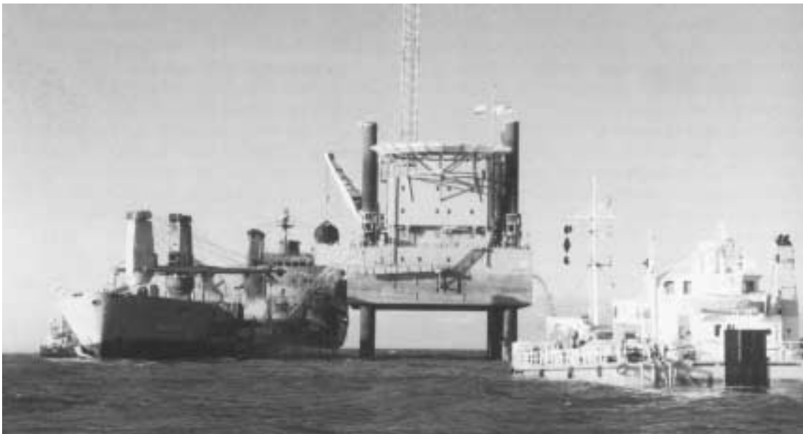
Abb. 51: Die Hubinsel Barbara diente als Plattform für die Brandbekämpfungs- und Ölbeseitigungsmaßnahmen auf dem Wrack der Pallas (MORDHORST, 1999).
