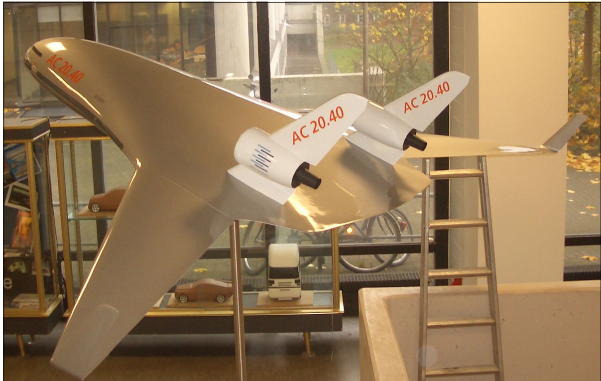
Abb. 4.9.: Modell eines Blended Wing Body Flugzeuges. (Quelle: Eigene Aufnahme vom 07.11.2008 im Foyer des Departments für Fahrzeugtechnik und Flugzeugbau der Hochschule für Angewandte Wissenschaften in Hamburg)
