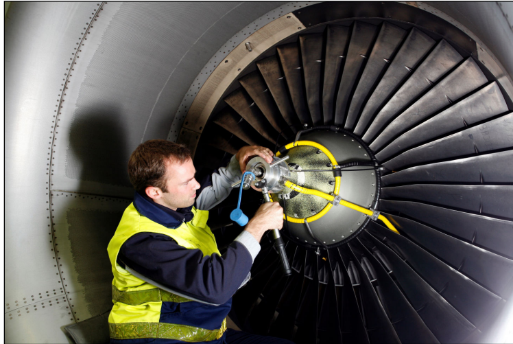
Abb. 4.10.: Das Cycleclean Engine Wash Verfahren bei der Anwendung. (Quelle: Aus Lufthansa Technik 2008a)
